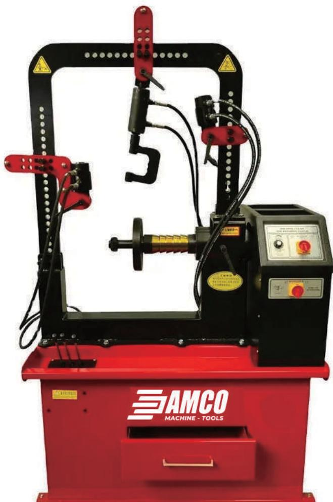
Alisadora de llantas, máquina de enderezamiento de llantas de llanta, Alisador de llantas
