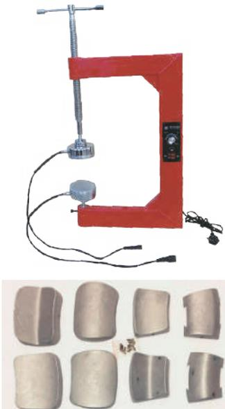
El vulcanizador con presión neumática TRAD001Q está destinado a la reparación de varios tipos de neumáticos sin cámara. Se instala fácilmente en cualquier lugar conveniente para usted, ya que es estacionario y portátil. Está equipado con un cabezal de calentamiento, un controlador de temperatura y un dispositivo de presión de tipo neumático. Protección contra cortocircuitos. El temporizador le permite configurar el tiempo de vulcanización.
